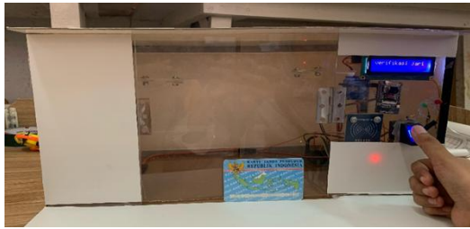
Gambar 18 Fingerprint Sensor dan Tampilan LCD
