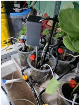
Gambar 10. Sensor Mendeteksi Ph Tanah
